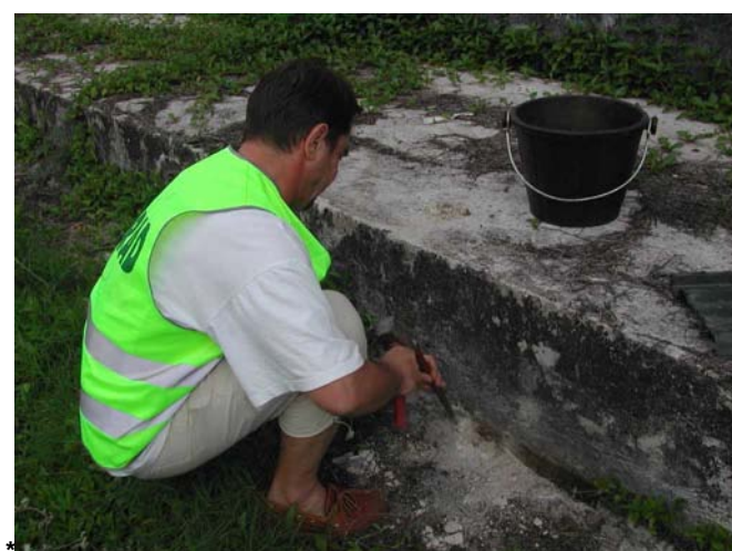
T4 / N°15 : échantillonnage de ciment poreux de l'ancien caniveau de récupération des eaux de lavage de la façade ouest du toit du hangar destiné à protéger la population à Rikitea (Mangareva). CRIIRAD, le 8 octobre 2005.
