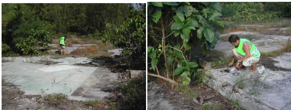
T6 / N°120 et 128 : contrôles radiométriques sur la plateforme de l'ancien Centre Technique de Décontamination, secteur CEA au Sud du village d'Otepa à Hao . CRIIRAD, le 12 octobre 2005.
