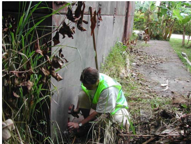
T3 / N°153 : échantillonnage de fibrociment dans l'ancienne canalisation de récupération des eaux de toiture du blockhaus destiné à protéger les militaires à Taku (Mangareva). L'épaisseur des murs est de 60 centimètres. CRIIRAD, le 8 octobre 2005.
