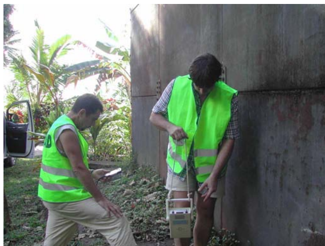
T2 / N°135 : contrôles radiométriques au voisinage de l'ancien blockhaus destiné à protéger les militaires à Taku (Mangareva). CRIIRAD le 5 octobre 2005.
