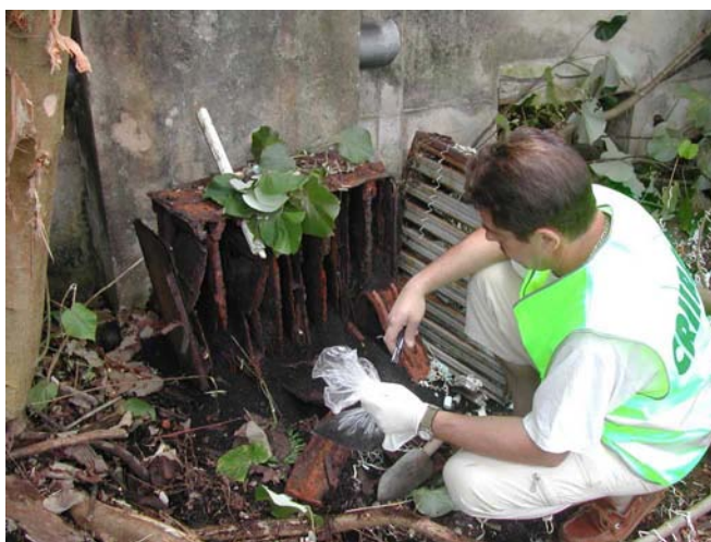
T3 / N°82 : échantillonnage du charbon actif destiné à épurer l'air des iodes radioactifs avant insufflation dans le hangar destiné à la protection des populations lors des retombées radioactives à Rikitea (Mangareva). CRIIRAD, le 7 octobre 2005.
